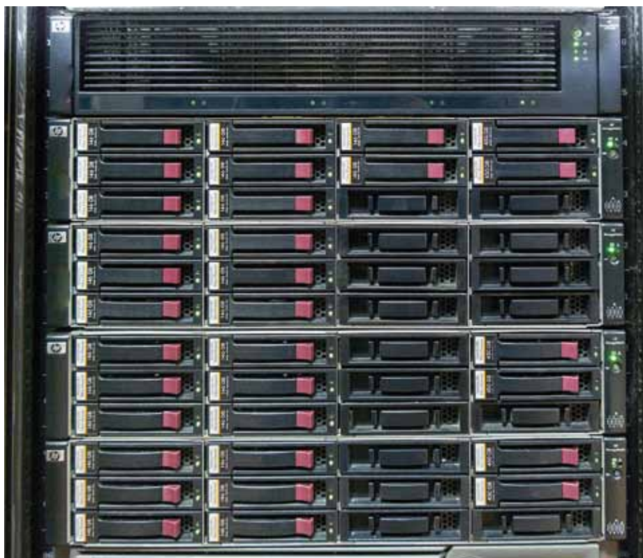
Diskovno polje HP iz krmilnika in štirih diskovnih polic s prostorom za 12 diskov na polico.
