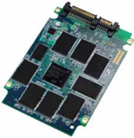
Notranjost »klasičnega SSD« z volidom SATA sestavljajo le krmilnik in čipi z bliskovnim pomnilnikom.
