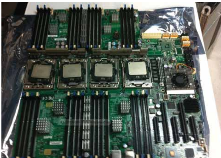
4-procesorski strežnik s pomnilniškimi moduli ob vsakem procesorju
