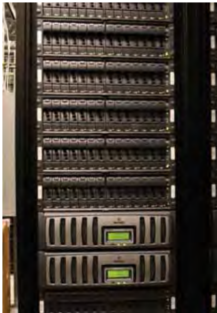
Diskovni podsistem z več krmilniki z običajnega zornega kota
