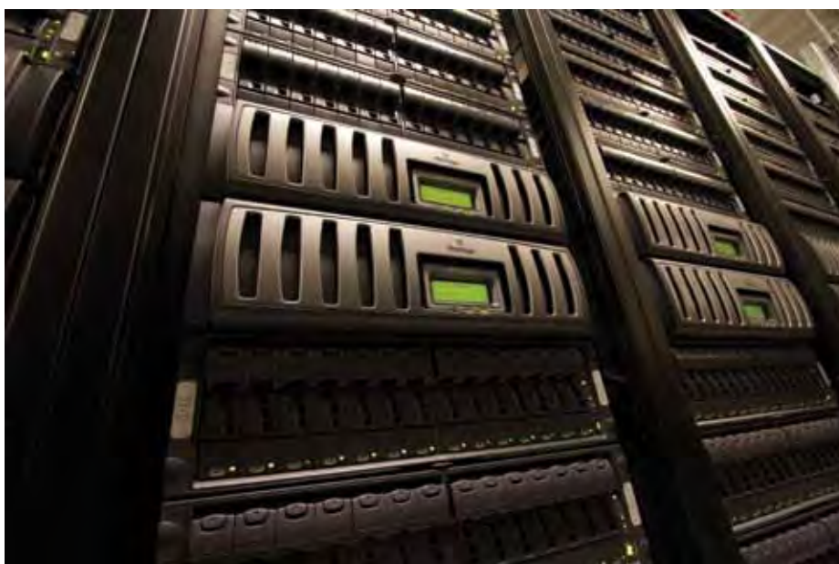
Diskovni podsistem z več krmilniki
