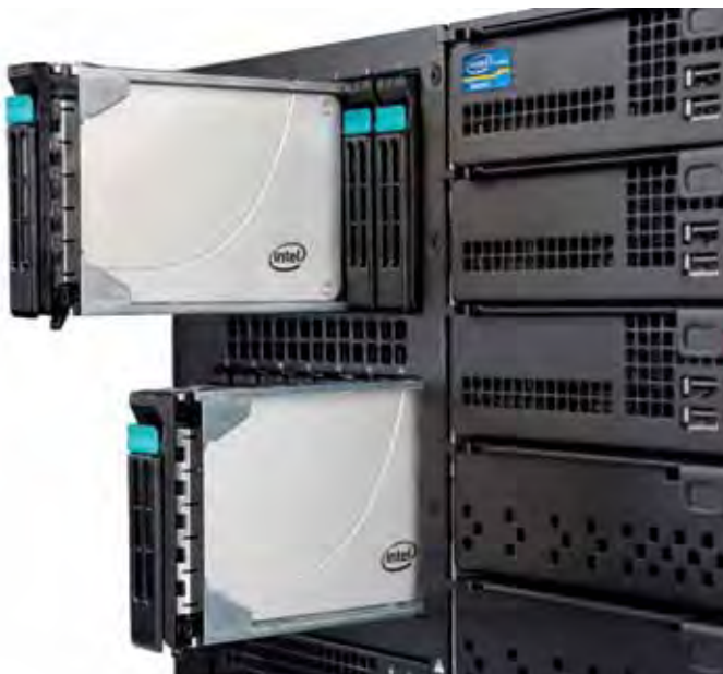
Vgradnja SSD v podatkovni strežnik
